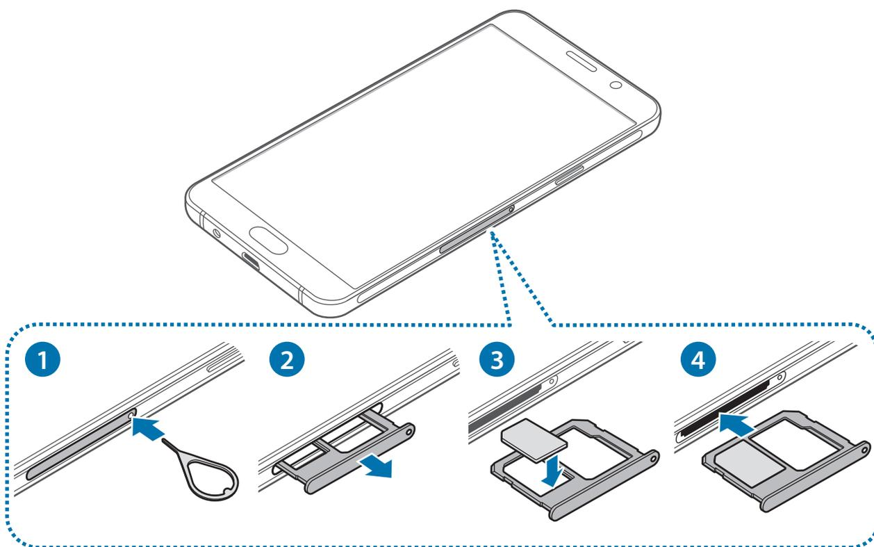
1 Führen Sie das Steckplatzwerkzeug in die Öffnung am SIM-Kartenhalter ein, um das Fach zu lösen.
