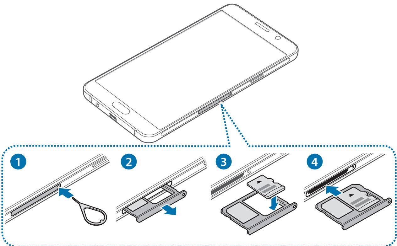
1 Führen Sie das Steckplatzwerkzeug in die Öffnung am Speicherkartenhalter, um das Fach zu lösen.
