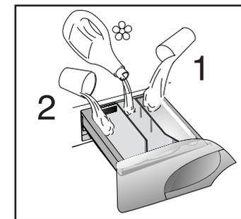
Für Flüssigwaschmittel benutzen Sie bitte den beiliegenden Einsatz, der wie abgebildet in die Waschmittelkammer "2" der Waschmittelschublade einzusetzen ist.
