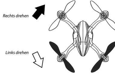
Mit dem Steuerhebel für Drehen wird der Quadcopters nach links/ rechts gedreht.
