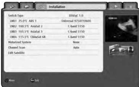
Falls Sie 2 oder mehr Satelliten empfangen, müssen Sie die Satelliten den DiSEqC-Schaltsignalen zuordnen und die Schalterart auswählen. Dies ist abhängig von der Installation Ihrer Satelliten-Anlage. Kurz, DiSEqC Anschluss 1 wird LNB/Satellit 1 zugeordnet, DiSEqC Anschluss 2 wird LNB/Satellit 2 zugeordnet, usw.
