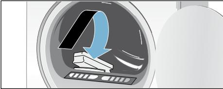
Tür öffnen und Feuchtigkeitsfühler mit einem angerauhten Schwamm reinigen.
