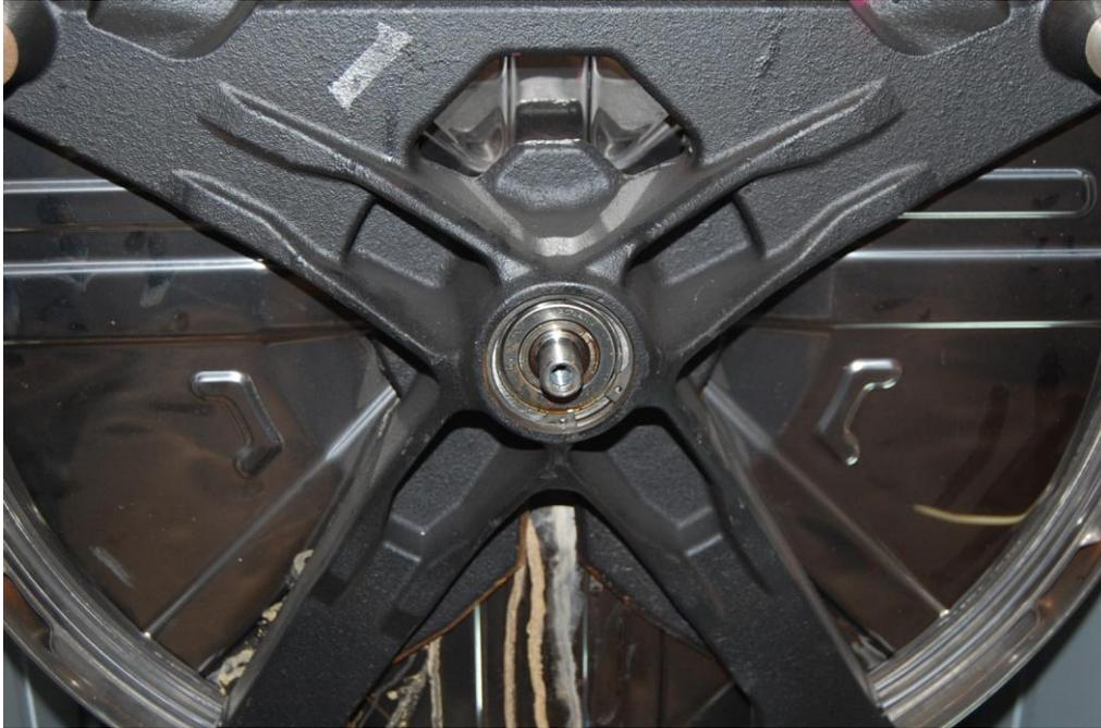
Danach wird die Konusbuchse von der Welle gezogen. Diese eventuell vorsichtig etwas aufbiegen. Man erkennt gut die Rostspuren an der Bottichrückwand und dem Lager.
