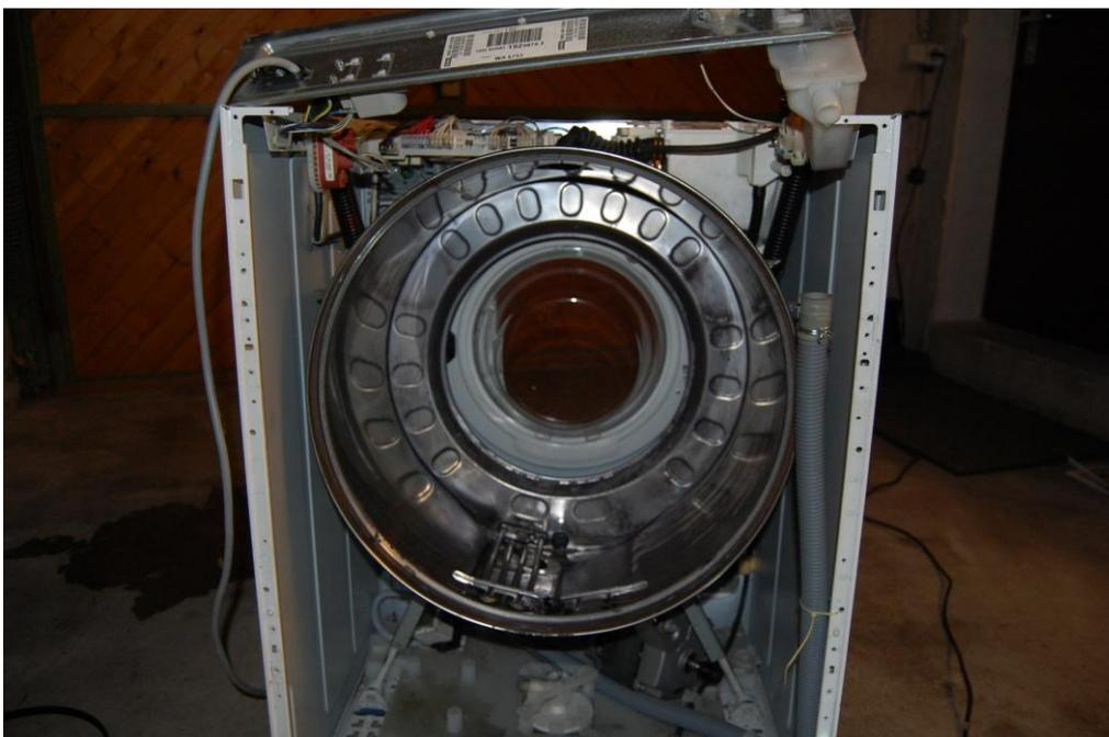
Auf dem Foto erkennt man den geöffneten Bottich nach Entfernen des Lagerkreuzes, der Bottichrückwand und der Trommel.
