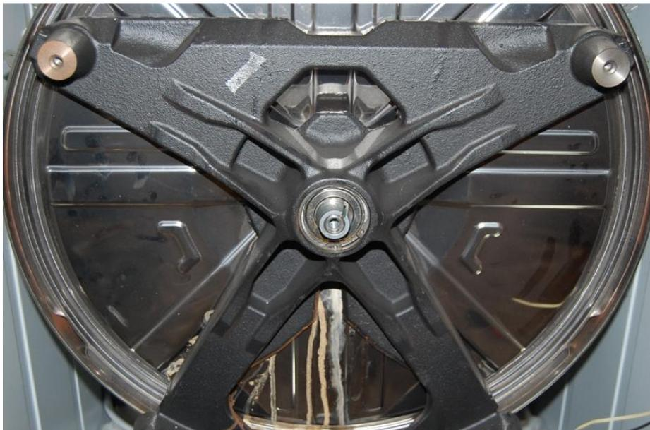
Nun werden die Zentralschraube der Riemenscheibe raus geschraubt und die Riemenscheibe abgezogen. Zum Lösen der Schraube die Riemenscheibe blockieren, z.B. ein Holz durchstecken und am Lagerkreuz abstützen.
