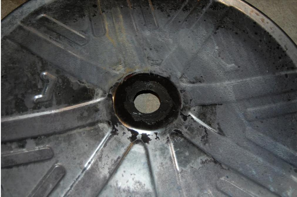
... besonders in dem Bereich, wo später die Dichtung läuft, sorgfältig reinigen und mit Graphitfett fetten.
