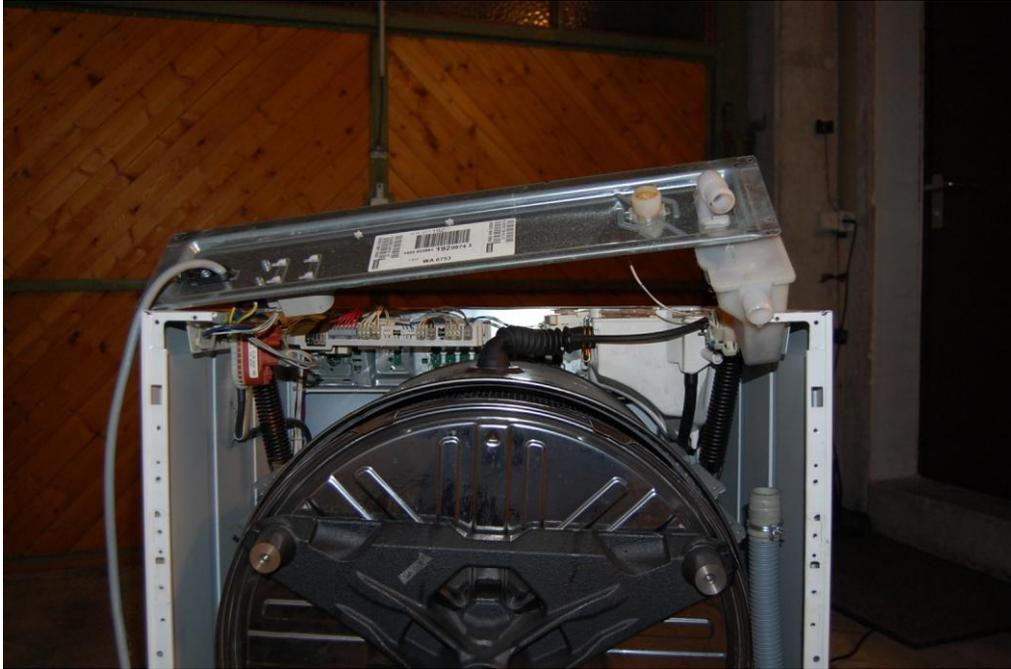
...danach kann man die Querstrebe abschrauben und auf das Gerät legen. Darauf achten, dass links die Leitungen nicht beschädigt werden.
