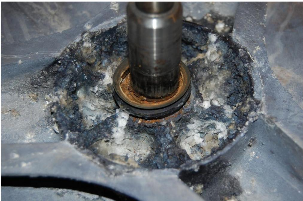
... und so nach Abnehmen der Bottichrückwand. Man erkennt die defekte Wellendichtung, die normalerweise mit der Dichtlippe auf der Bottichrückwand läuft und hier die Welle abdichtet. Alte Wellendichtung wird entfernt und die Trommel incl. Trommelkreuz und Welle werden gereinigt. Rostansätze habe ich mit ganz feinem Schmirgel entfernt.
