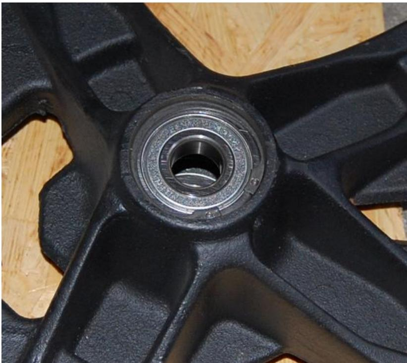
Sicherungsring bei dem kleineren Lager wieder einsetzen.
