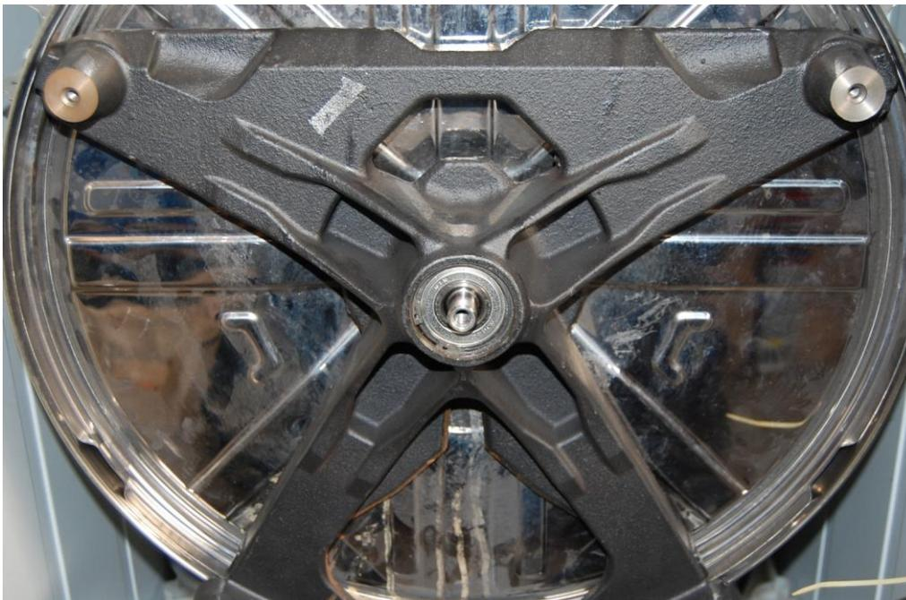
Sobald die Welle korrekt in den Lagern sitzt, kann das Lagerkreuz wieder am Bottich befestigt werden (4 Schrauben außenrum). Die Bottichrückwand wird dadurch gleichzeitig befestigt. Danach die Trommel auf korrekten Lauf kontrollieren (leichtgängig, gerade und ohne Spiel).
