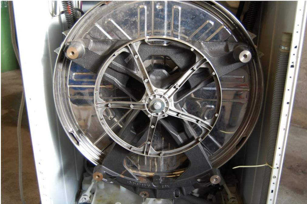
Ist alles in Ordnung, werden Konusbuchse und Riemenscheibe eingebaut. Hinter die Riemenscheibe muss die große Unterlegscheibe. Zur Montage eine **neue** Schraube verwenden!
