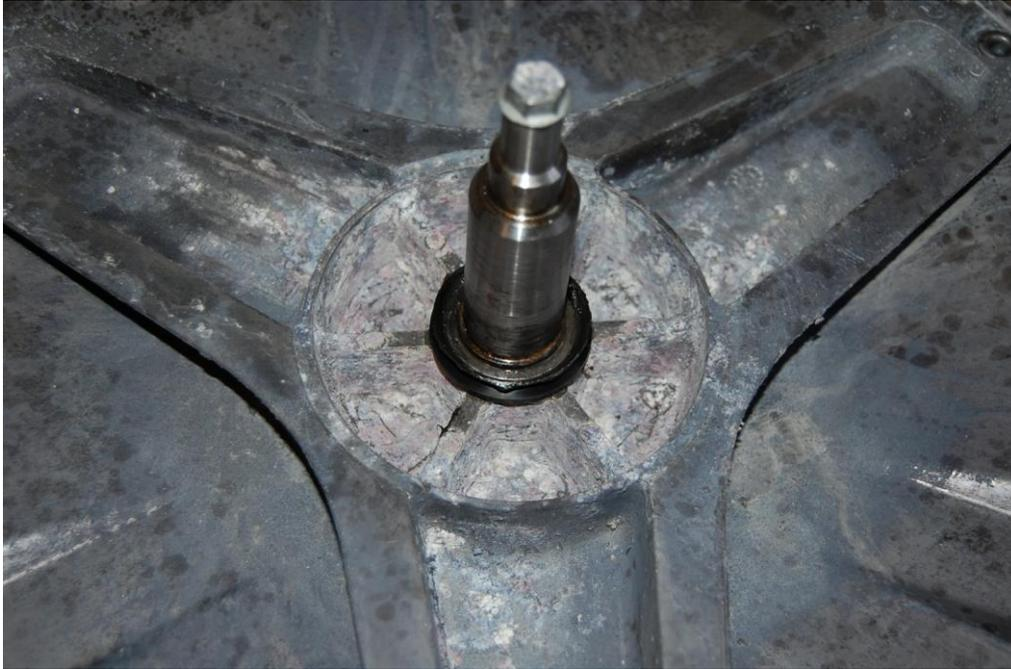
Direkt vor dem Trommelkreuz ist auf der Welle eine breitere Stelle. Hier alles gut saubermachen und neue Wellendichtung mit dünner Lippe vom Trommelkreuz weg an dieser Stelle mit Gummi-Kleber aufkleben. Ich habe die Sache anschließend eine Nacht trocknen lassen.
