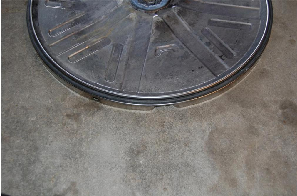
**Neue** Bottichdichtung an der Rückwand in die vorher gereinigte Nut einlegen. Eine neue Bottichdichtung, weil die alte gern mit festsitzenden Waschmittelresten verunreinigt ist und nicht mehr gut dichtet bzw. anliegt.
