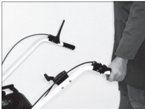
2) Mit der linken Hand wird der Fahrtrieb eingeschaltet.
