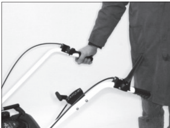
1) Durch Drücken des rechten Schalthebels schaltet man die Kehrbürste ein.
