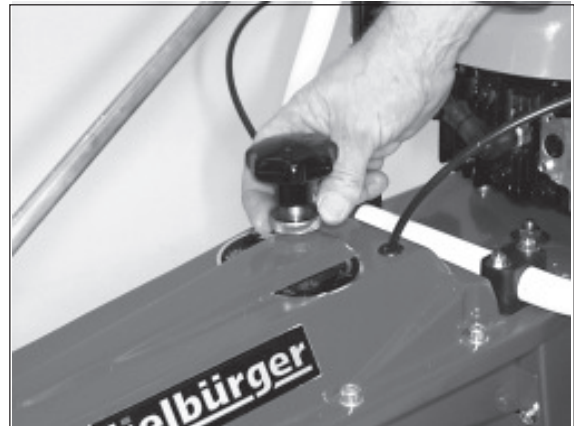
2) Oberhalb des Stützrades befindet sich der Einstellknopf. Feststellrad lösen.
