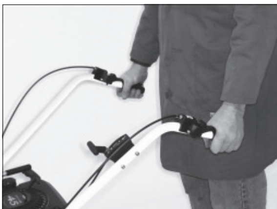
3) Durch Betätigen beider Schalthebel werden sowohl Kehrbürsten- als auch Fahrtrieb eingeschaltet.
