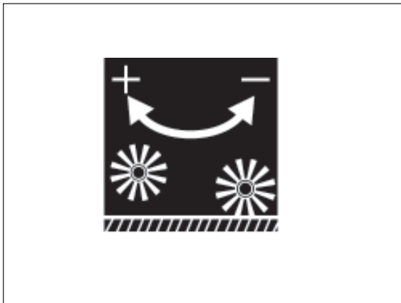
3) Drehen im Uhrzeigersinn (+) : Bürste anheben Entgegen dem Uhrzeigersinn (-) : Bürste absenken
