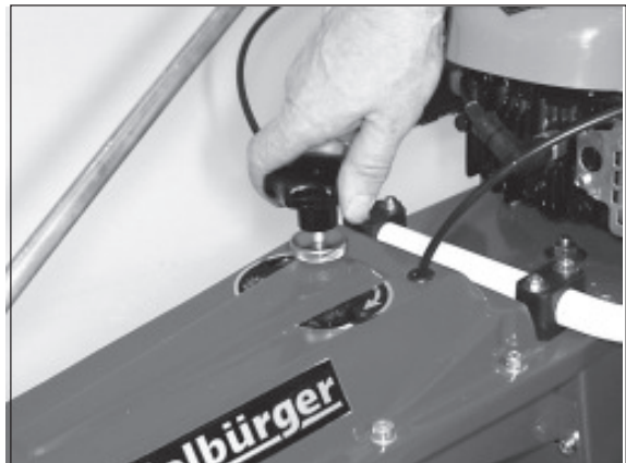
4) Senken Sie die Bürste so weit ab, dass sie gerade eben den Boden berührt. Dann noch 2 Umdrehungen entgegen dem Uhrzeigersinn in Pfeilrichtung (-) drehen.
