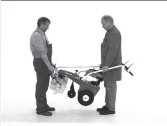
1) Anheben der Maschine.
