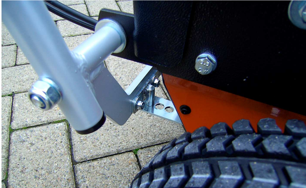
Abbildung 6: korrekte Montage des Rastfingers
