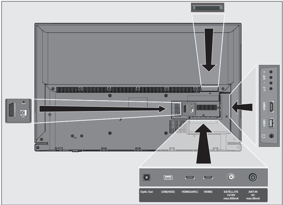
**LAN** Buchse zum Anschließen an das Heimnetzwerk über LAN-Kabel.
