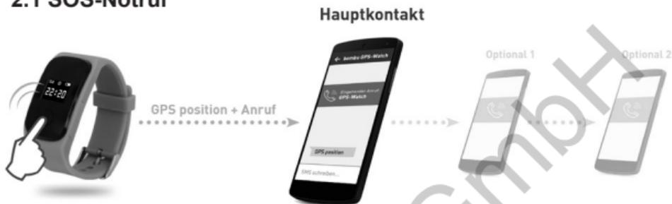
Drücken Sie 3 Sekunden auf die SOS-Taste um den Notruf zu starten. Es werden nacheinander die gespeicherten Kontaktnummern angerufen bis einer der Kontakte den Anruf annimmt. Nimmt kein Kontakt den Anruf entgegen, wird die Schleife insgesamt dreimal wiederholt. Zusätzlich wird die aktuelle Position per SMS verschickt.
