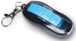
**Netzschalter:** Wenn der **ROBWAY EBALANCE W1** nicht im Fahrmodus ist, wird durch das anhaltende Betätigen dieser Taste das Gerät ausgeschaltet.
