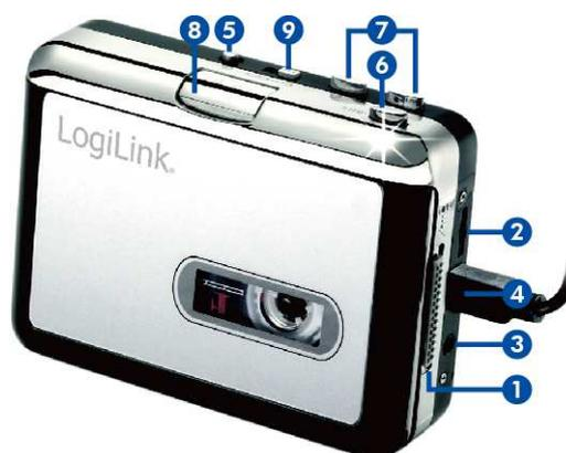
1. **Auswurfschalter:** Schieben Sie den Schalter nach unten um das Kassettenfach zu öffnen.
