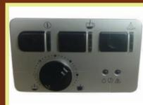
1. Drücken Sie den Einschaltknopf und warten Sie, bis die Anzeigeleuchte für die Wassertemperatur (18) dauerhaft leuchtet. Drücken Sie dann den Knopf für die Auswahl von heißem Wasser oder Dampf (19). Die Anzeigeleuchte für den Dampf (20) beginnt zu blinken, warten Sie mit dem nächsten Schritt, bis das Blinken aufhört.
