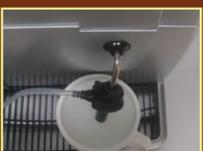
4. Bitte drehen Sie nach dem Schäumen den Knopf für heißes Wasser & Dampf (12) zurück (schließen Sie ihn). Drücken Sie dann den Auswahlschalter für heißes Wasser oder Dampf (19). Sowohl die Anzeigeleuchte für die Wassertemperatur (18) als auch die Anzeigeleuchte für Dampf (20) blinken. Drehen Sie dann den Knopf für heißes Wasser & Dampf (12), bis die Anzeigeleuchte für die Wassertemperatur (18) dauerhaft leuchtet. Das bedeutet, dass Sie erneut Kaffee zubereiten können, falls nötig.
