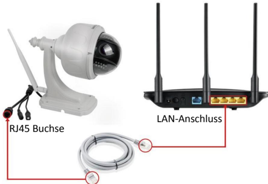
Fig.1.1 Verwendung des Netzkabels um die Kamera mit dem Router zu verbinden
