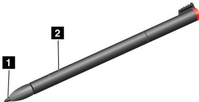
Der Tablettdigitalisierstift verfügt über eine Spitze **1** und eine Klicktaste **2**. Halten Sie den Stift fest, und zeigen Sie mit der Spitze auf den LCD-Bildschirm, um den Zeiger zu verschieben.
