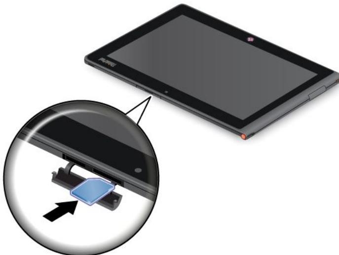
4. Schließen Sie die Abdeckung des SIM-Kartensteckplatzes und starten Sie das Tablet neu.
