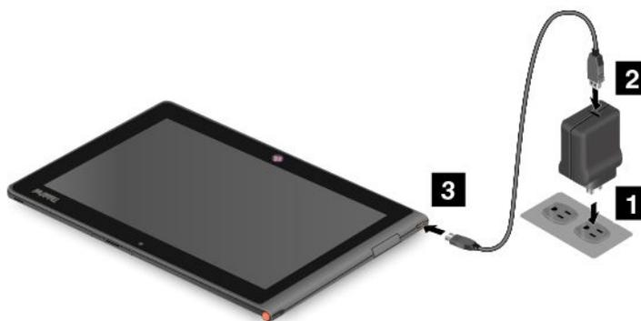
Abbildung 4. Verbinden des Netzteils mit dem Tablet
