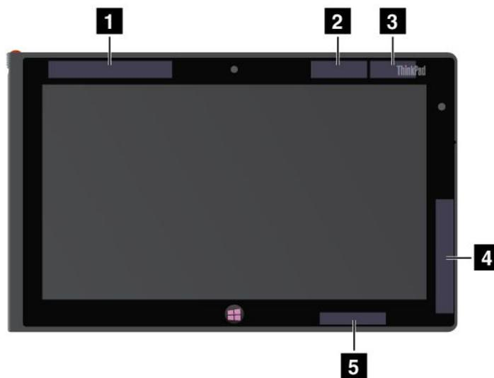
Abbildung 12. Position der UltraConnect-Antennen für drahtlose Verbindungen
