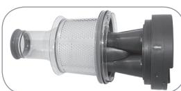
7. Het cycloonfilter kan uiteen worden gehaald om het een voudiger te reinigen: draai het binneste cyclooninzetstuk een beetje om het los te maken, en trek het dan eruit.
