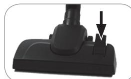
Die Bodendüse ist sowohl für Teppiche als auch für glatte Böden geeignet. Für glatte Böden klappen Sie den Fußschalter um. Dadurch wird auf der Unterseite der Düse eine Bürste ausgefahren.
