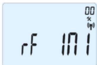
La commande à distance (émetteur) enverra maintenant le signal de configuration radio au ventilateur (récepteur). Les 4 témoins à Led verts du ventilateur s'éteindront. Ceci est le signal du fait que la configuration entre le ventilateur et la commande à distance a bien eu lieu. Sur la commande à distance, appuyer sur la touche Escape (↵) sur le clavier pour retourner à la page-écran principale.
