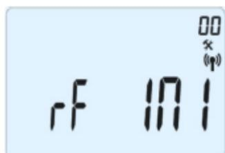
Il controllo remoto (trasmettitore) invierà ora il segnale di configurazione radio al blower (ricevitore). I 4 led LED verde del blower si spegneranno. Questo è il segnale di avvenuta configurazione tra blower e controllo remoto. Sul controllo remoto premere il tasto Escape (↶) sulla tastiera per tornare alla schermata principale.
