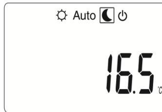
La temperatura nominal de funcionamiento económico es constantemente mantenida con un valor ajustable entre 5°C y 35°C con pasos de 0,5°C.
