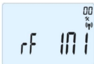
El control remoto (transmisor) enviará la señal de configuración radio al calefactor (receptor). Los 4 leds verdes del calefactor se apagarán. Esta señal indica que se ha realizado correctamente la vinculación entre el calefactor y el control remoto. Pulsar la tecla Escape (↶) del teclado del control remoto para volver a la pantalla principal.
