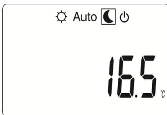
La température nominale de fonctionnement economy est constamment maintenue avec une valeur pouvant être configurée entre 5 °C et 35 °C par étapes de 0,5 ° C.
