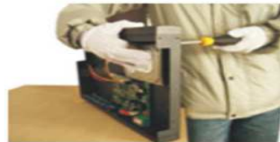
1. Installieren Sie die Schraube für HDD
