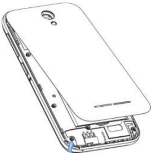
2. Halten Sie die SIM-Karte so, dass die abgeschrägte Ecke wie dargestellt ausgerichtet ist, und schieben Sie die Karte in den Kartenhalter.
