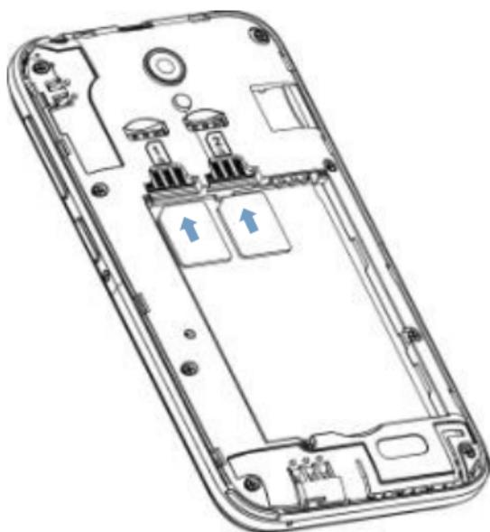
3. Setzen Sie die Speicherkarte mit den Metallkontakten nach unten in den Steckplatz ein, bis Sie hörbar in die korrekte Position einrastet.
