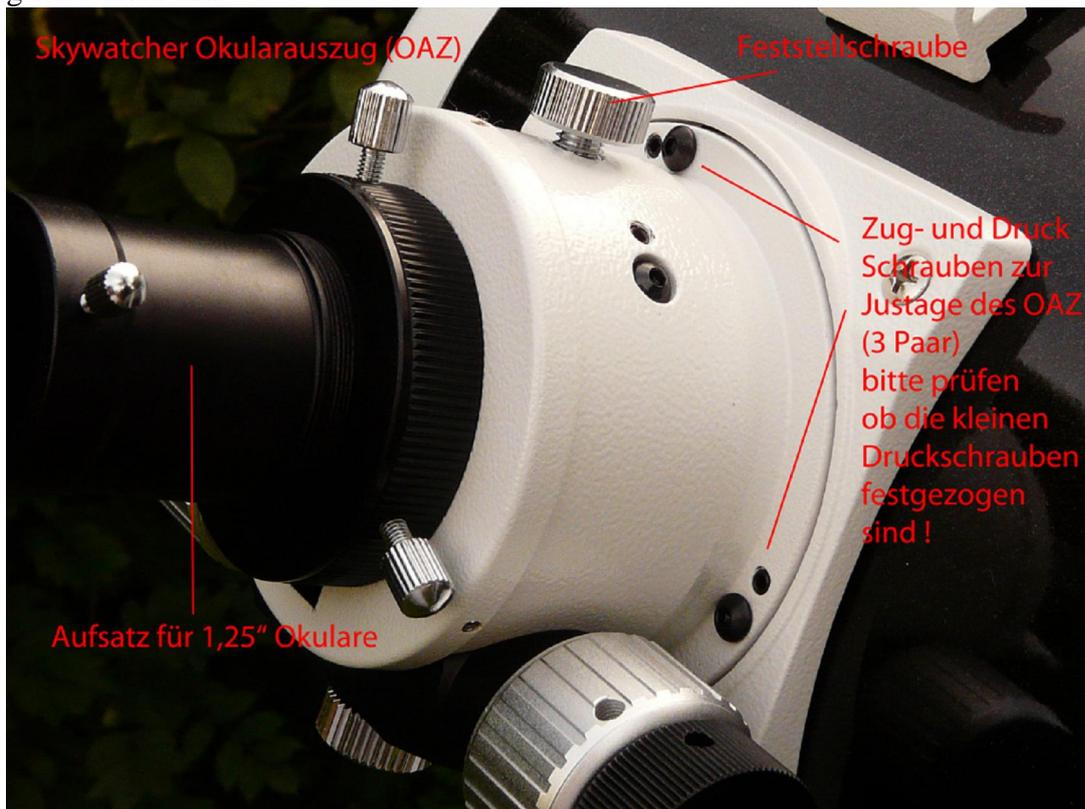
Also zuerst prüfen ob die Druckschrauben festgezogen sind! Später mal kann man die zur genauen Ausrichtung des OAZ zum Tubus benutzen. Jetzt kommt die Hauptaufgabe, die Einstellung des FS. Auf drei Dinge gleichzeitig muss man achten:
