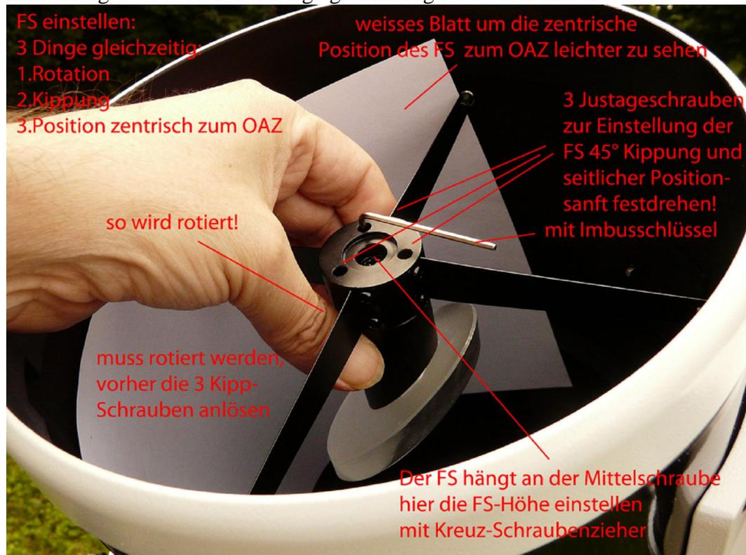
Ein weisses Blatt Papier, gegenüber dem OAZ angeklebt, hilft sehr um die Position des FS zentrisch zum OAZ zu machen. Sonst ist das vor lauter Schwärze im Tubus kaum zu sehen. Man muss in den OAZ schauen und sehr Acht geben, mit dem Auge möglichst auf der Achse des OAZ-Rohrs zu sein. Das OAZ-Rohr muss ganz symmetrisch rund aussehen. Hier tut man sich mit einem Cheshire Okular viel leichter. Mit einigem Gefühl bekommt mans hin:
