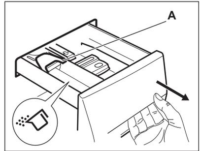
4. Drehen Sie die Klappe nach unten, wenn Sie Flüssigwaschmittel verwenden.
