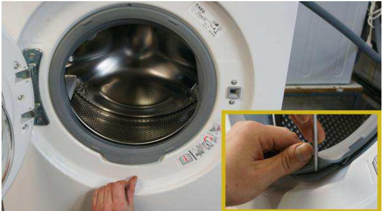
© diybook | Der nächste Schritt, um die Frontblende zu entfernen, beinhaltet das Lösen der Manschette von derselben. Dazu wird die...
