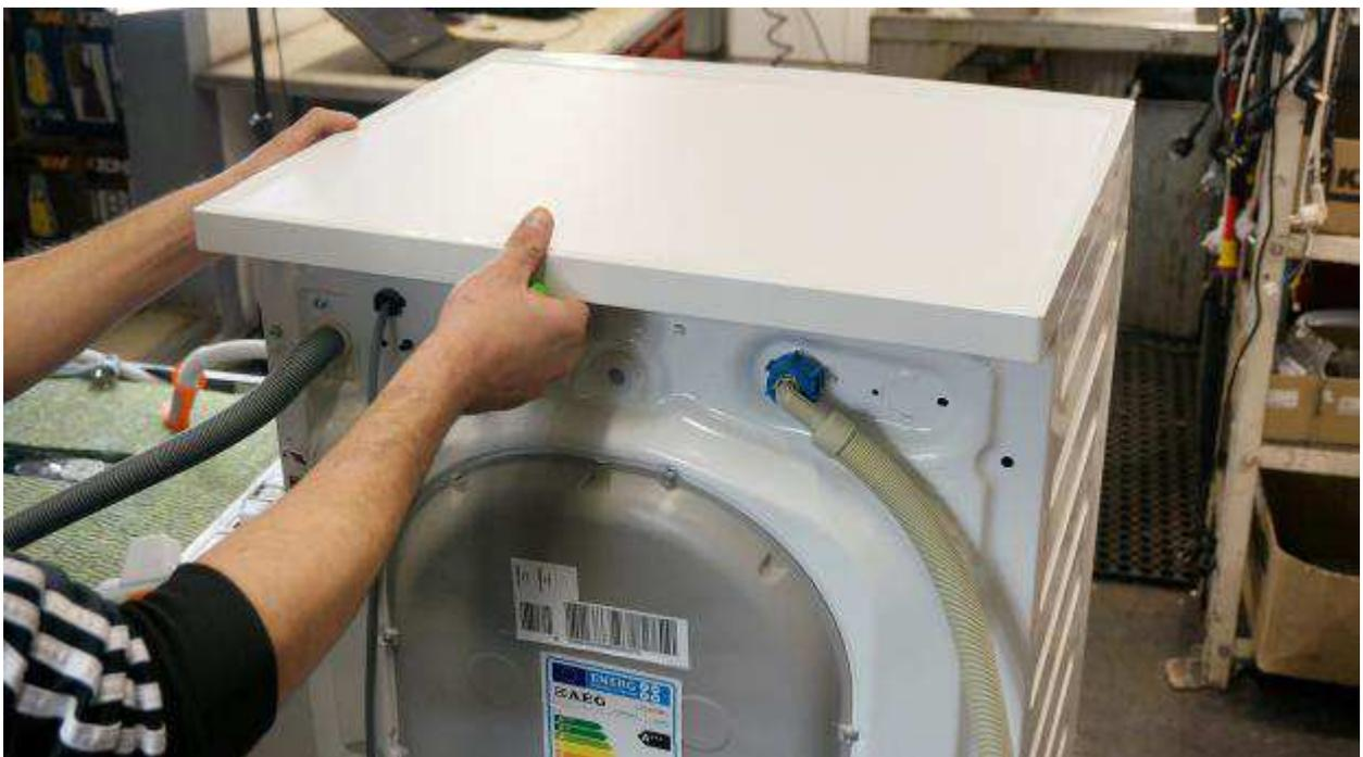
© diybook | Sind die Schrauben entfernt, kann der Deckel nach hinten geschoben und entfernt werden.
