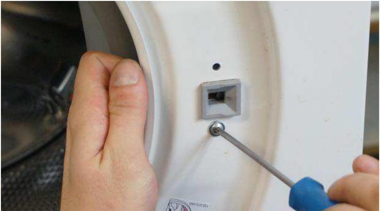
© diybook | Es folgt das Entfernen des Türschlosses. Dazu müssen zunächst die zwei Schrauben mit Torx-Kopf gelöst werden.
