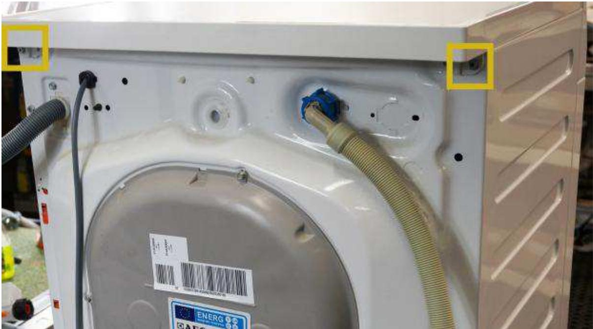
© diybook | Um die Frontblende der Waschmaschine entfernen zu können, muss zunächst der Gehäusedeckel abgenommen werden. Dazu werden...
