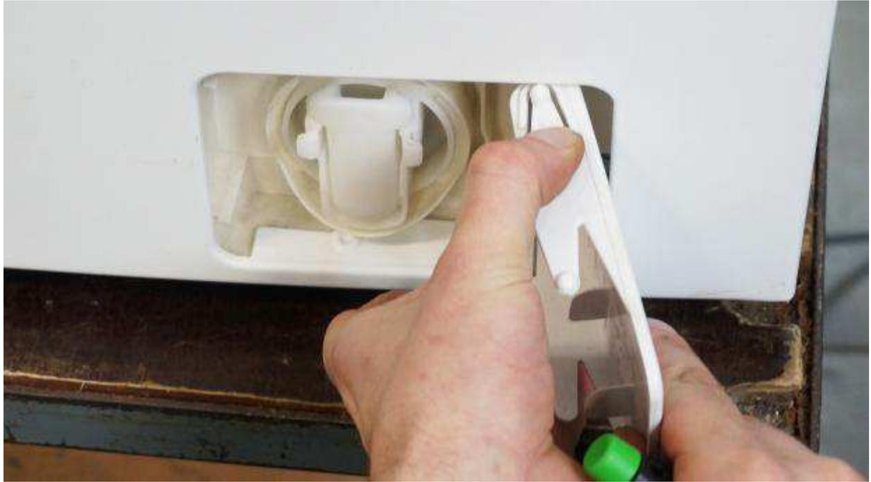
© diybook | Als letzter Schritt vor dem Entfernen der Frontblende wird die Flusensieb-Blende entfernt. Diese wird nahe der Scharniere..
