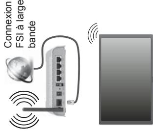
Un routeur sans fil-N (IEEE 802.11a/b/g/n) avec des bandes simultanées de 2,4 et 5 GHz est conçu pour augmenter la bande passante. Ces fonctions sont optimisées pour une transmission vidéo en HD plus claire et plus rapide et un transfert de fichiers et jeux sans fil faciles.
