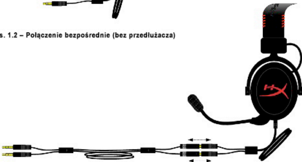
Rys. 1.3 – Połączenie bezpośrednie (z 2-metrowym przedłużaczem)
