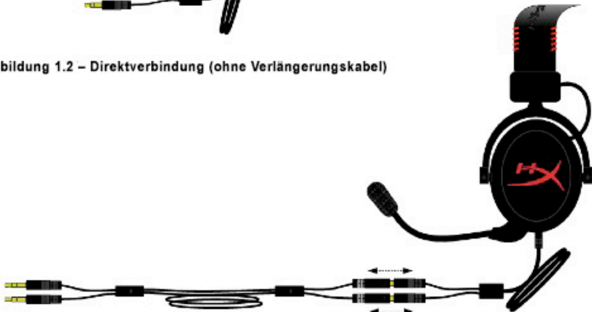
Abbildung 1.3 – Direktverbindung (mit 2-m-Verlängerungskabel)
