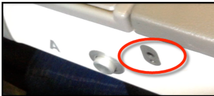
Рисунок 1.9 – Разъемы входа сиденья самолета (в подлокотнике)
