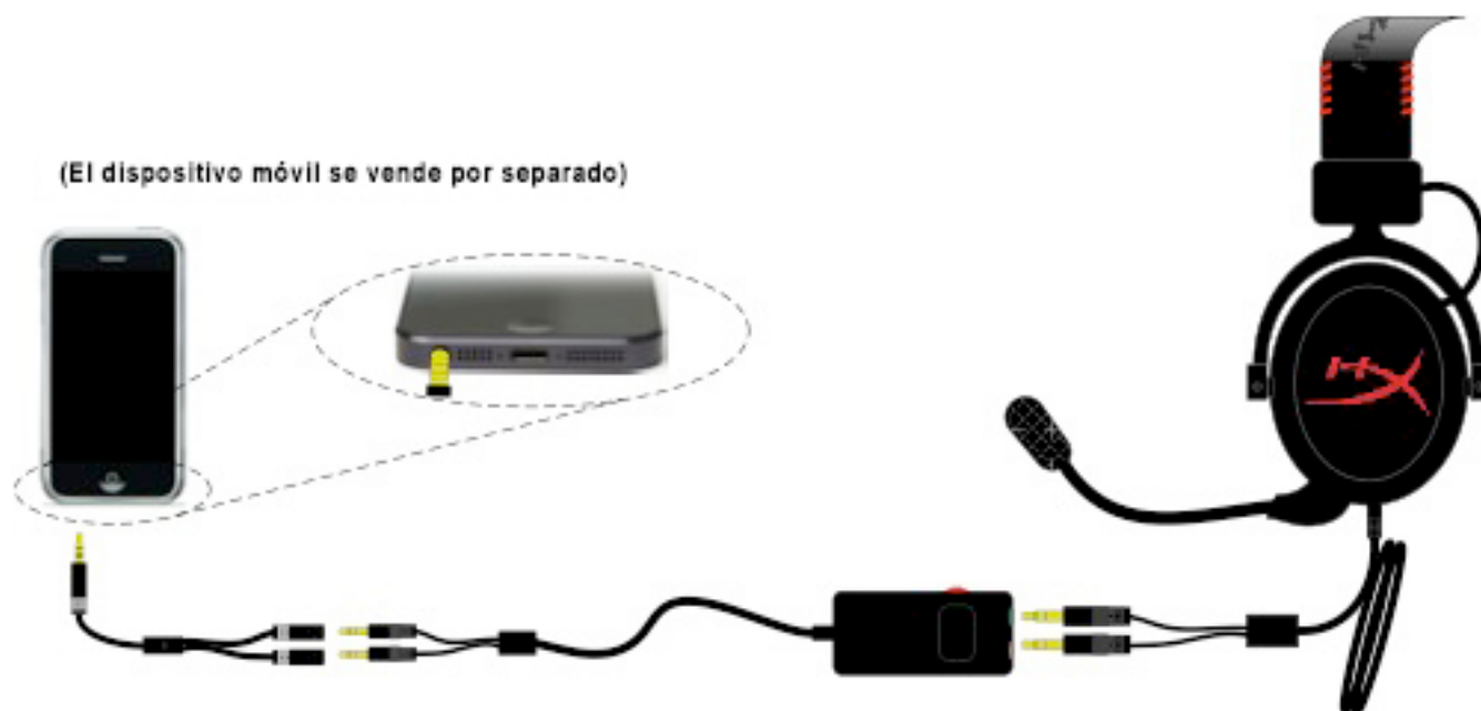
Figura 1.14 - Cómo utilizar un dispositivo móvil (teléfono o tablet)
