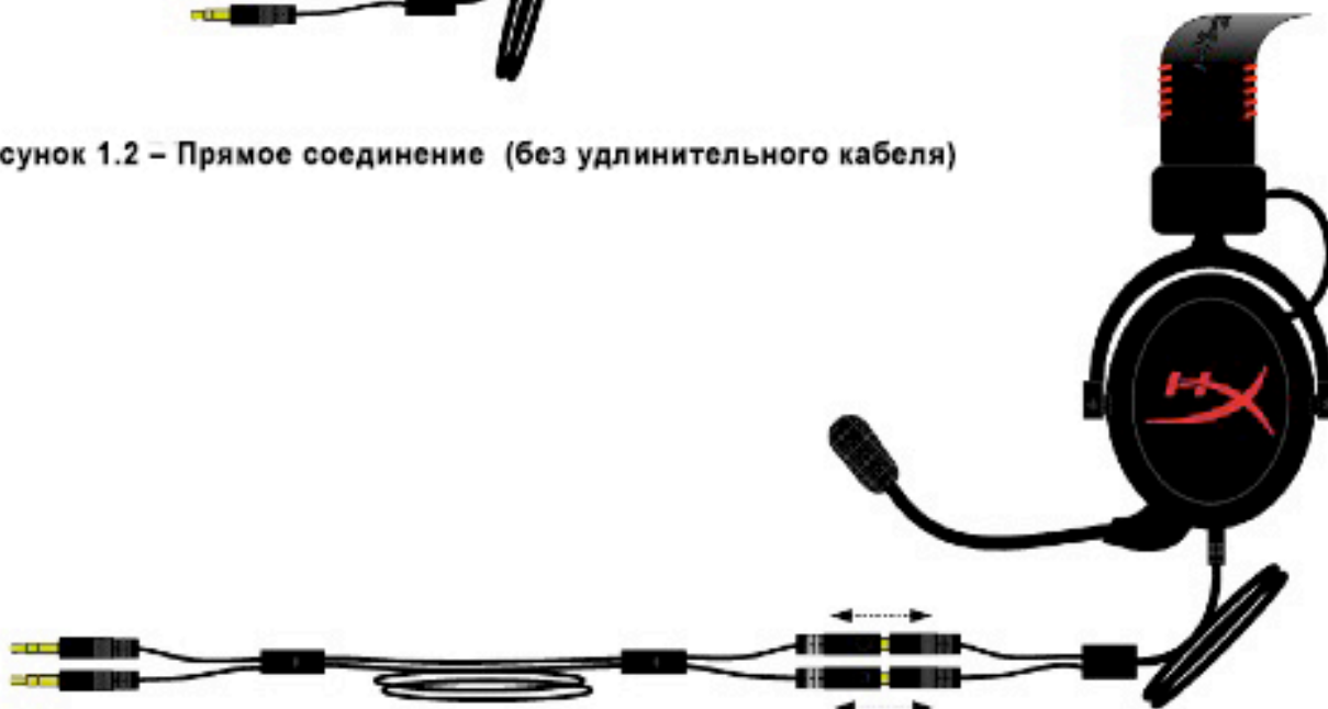
Рисунок 1.3 – Прямое соединение (с двухметровым удлинительным кабелем)
