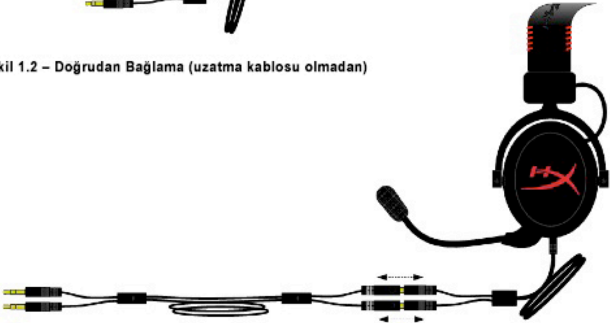
Şekil 1.3 – Doğrudan Bağlama (2 metre uzatma kablosu ile)
