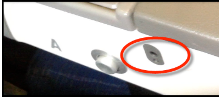
Figure 1.9 – Jacks d'entrée d'un accoudoir de siège d'avion
