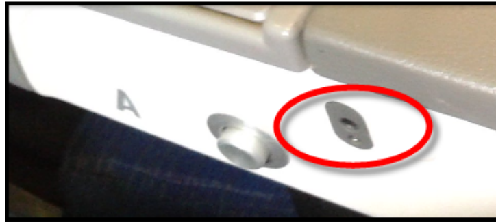
Рисунок 1.9. Вхідні роз'єми на підлокітнику сидіння в літаку
