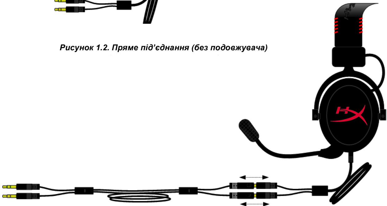
Рисунок 1.3. Пряме під'єднання (через кабель-подовжувач довжиною 2 метри).
