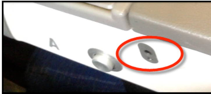
圖 1.9 – 飛機座椅 (扶手) 上的輸入插孔
