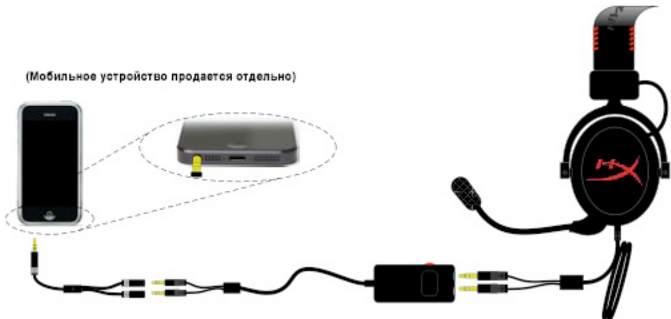
Рисунок 1.14 – Использование с мобильным устройством (телефоном или планшетом)
