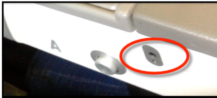
Abbildung 1.9 – Audioanschlüsse an einem Flugzeugsitz (Armlehne)
