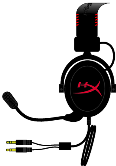
圖 1.2—直接連接 (無延長線)
