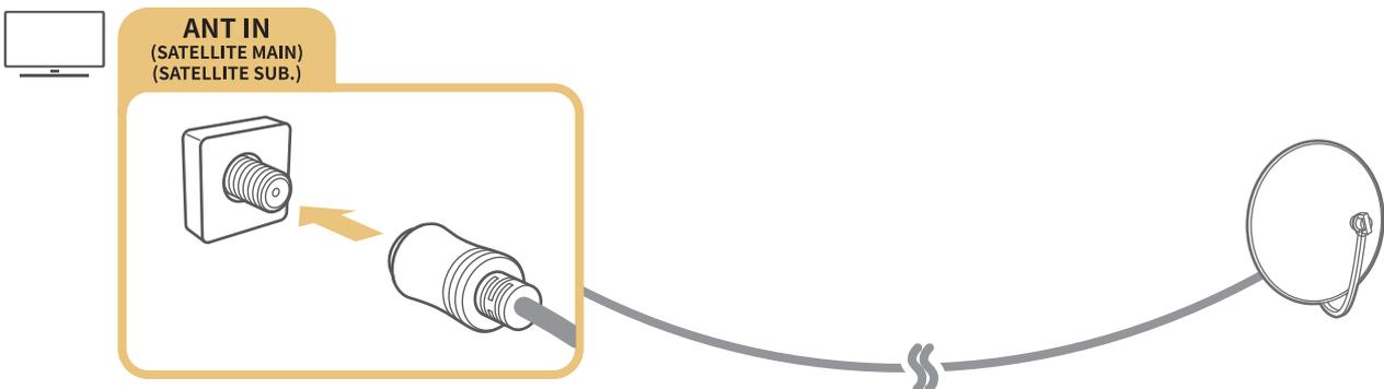
Am besten verbinden Sie beide Anschlüsse mit einem Multischalter oder DiSEqC- Schalter usw. und stellen die Funktion **Antennen-Verbindungstyp** auf **Zwei Oszillatoren** ein.
