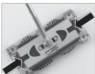
1. Damit die Bürsten besser zugänglich sind, entfernen Sie die Abdeckung des Reinigungsfußes. Schieben Sie dazu die beiden Schieberiegel auf dem Reinigungsfuß nach innen (siehe Abbildung) und nehmen Sie die Abdeckung ab.
