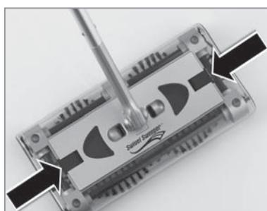
1. Afin de mieux accéder aux brosses, enlevez le couvercle de protection du pied de nettoyage. Pour ça, enfoncez les deux verrous à pousser sur le pied de nettoyage vers l'intérieur (voir illustration) et ôtez le couvercle de protection.
