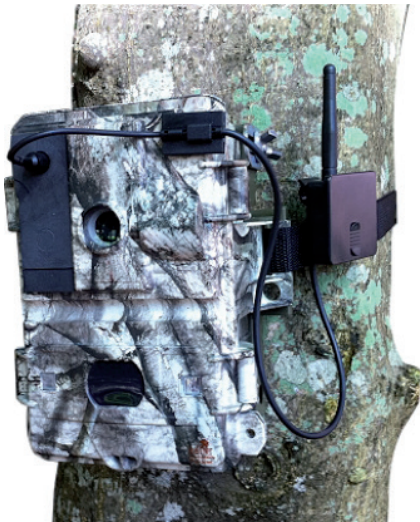
Wildkamera mit konventionellem (IR) Blitz, abgeklebt
