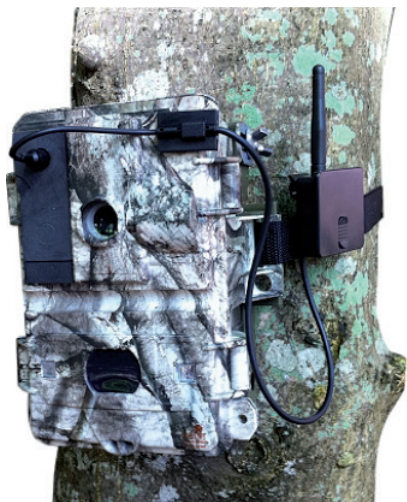
Piège caméra avec flash traditionnel (émettant une lumière rouge visible), recouvert d'un cache protecteur.
