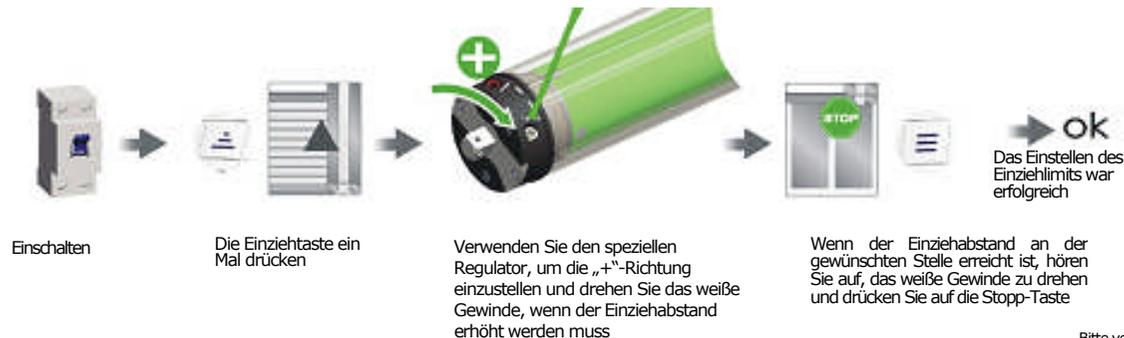
! Wenn der Motor nicht funktioniert, hören Sie auf, das rote oder weiße Gewinde mit dem Regulator zu drehen..
