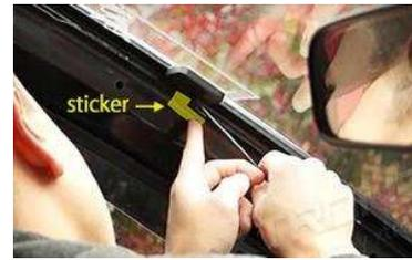
2. Kratzen Sie etwas Lack von der A-Säule, um die Kupfererdungsöse zu befestigen. (Bitte entfernen Sie den Aufkleber von der Oberfläche der Erdungsöse und stellen Sie sicher, dass eine gute Verbindung mit der Erdung des Fahrzeugs hergestellt wird.)
