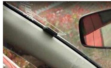
4. Führen Sie das Kabel zur Rückseite der DAB-Stereoanlage und verbinden Sie es zum Testen. Verkleiden Sie die A-Säule wieder, sobald Sie fertig sind.
