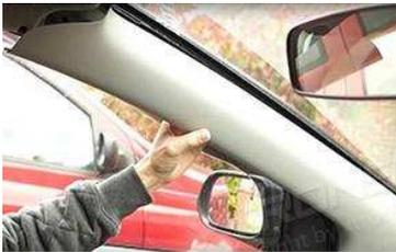
1. Entfernen Sie die A-Säulenverkleidung von der Passagierseite.
