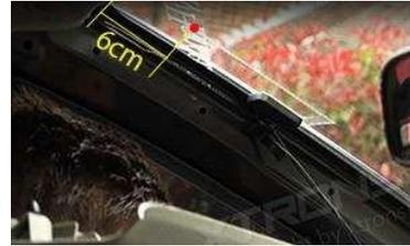
3. Bringen Sie die Antenne an der Windschutzscheibe an, sobald die Kupfererdungsöse gesichert ist. (Bitte halten Sie die Antenne von der Metallerdung des Fahrzeugs fern, zumindest 60mm, und die Antenne sollte aufwärts angebracht werden.)
