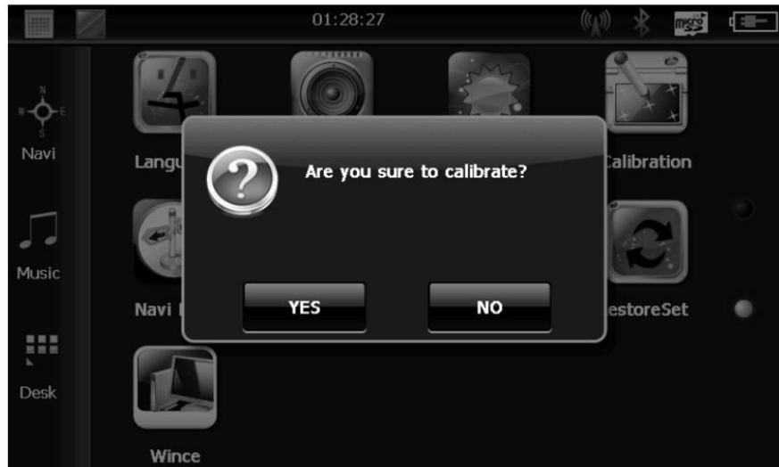
Klicken Sie auf **YES** und folgen sie den Angaben auf dem Display bis die Kalibrierung beendet ist. Nach beendeter Kalibrierung bitte 30 Sekunden warten, bis das Kalibrierungsprogramm automatisch beendet wird.
