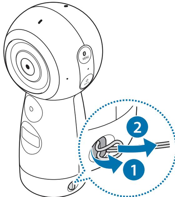
Mit dem Gummiring am Trageriemen können Sie die Gear 360 zum Aufnehmen von Videos oder Fotos befestigen.
