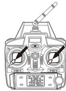
Beide Hebel der Fernbedienung nach links unten
