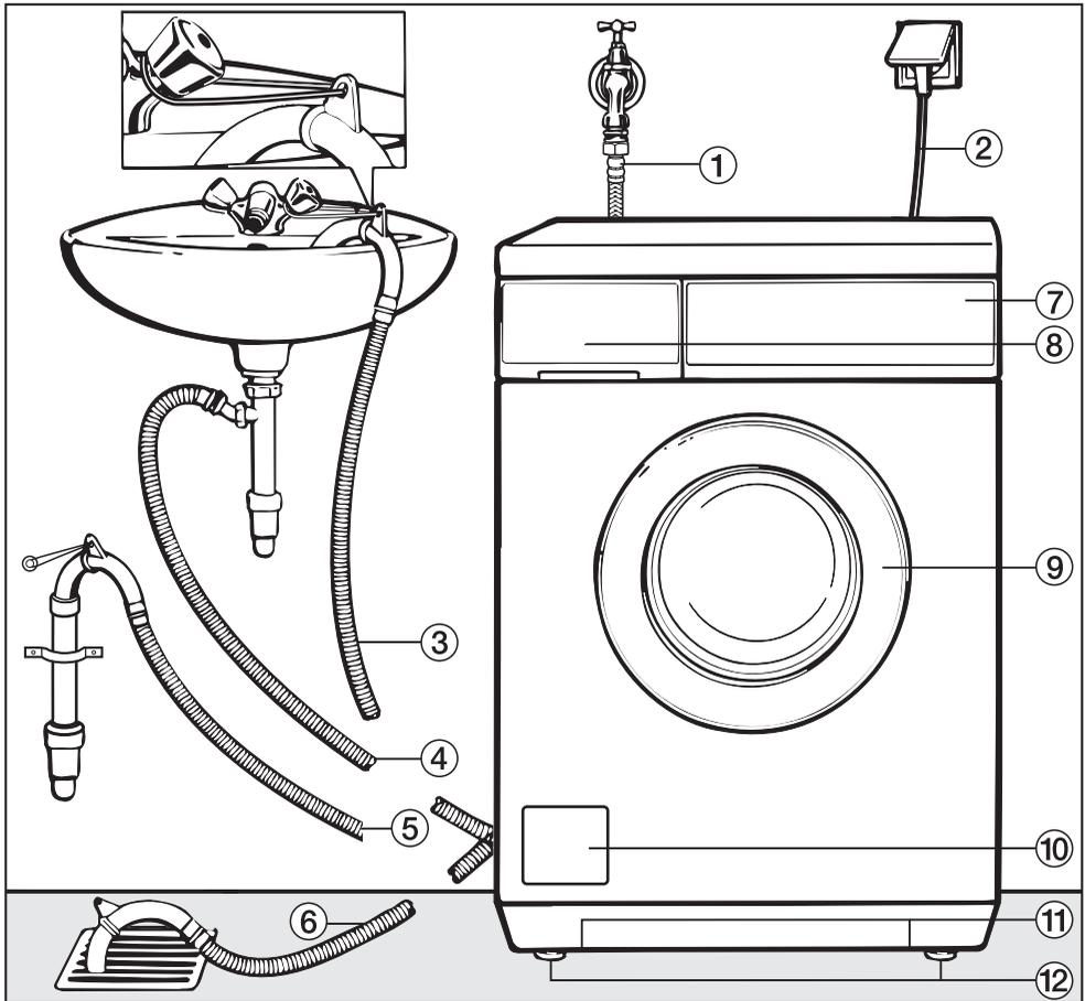
① Zulaufschlauch (Waterproof-Metal, Metallgewebeschauch)
