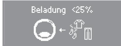
Das Display zeigt in 25%-Schritten an, wie viel Prozent der maximalen Beladungsmenge sich für das gewählte Programm in der Trommel befindet.
