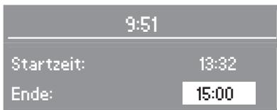
Beim ersten Tastendruck wird das Programmende auf die nächste volle oder halbe Stunde verschoben. Jeder weitere Tastendruck verschiebt das Programmende um 30 Minuten.
