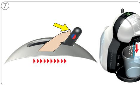
⑦ Bewegen Sie den Wahlhebel nach rechts. Der Entkalkungsvorgang dauert ca. 2 Minuten. Dabei startet und stoppt die Maschine mehrfach.
