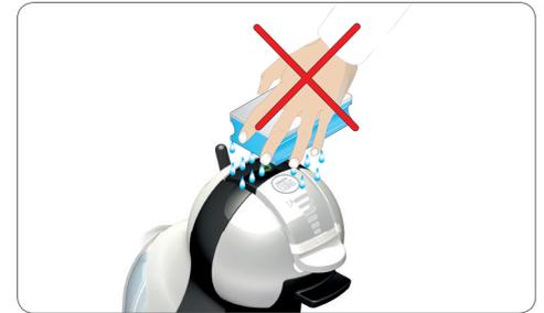
⚠️ Verwenden Sie zur Reinigung des Kopfteils der Maschine niemals einen nassen Schwamm sondern ein weiches feuchtes Tuch.
