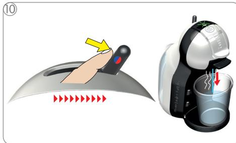
Bewegen Sie den Wahlhebel nach rechts, um den Spülvorgang zu starten. Warten Sie bis sich der Wahlhebel in die Mitte zurückbewegt und die Zubereitung abgeschlossen ist.
