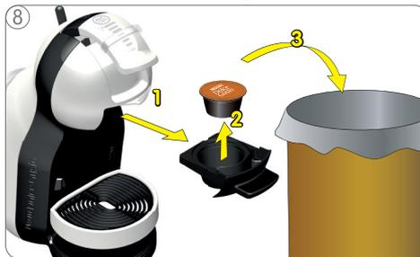
Kapselhalter herausziehen und gebrauchte Kapsel entfernen. Kapsel wegwerfen.
