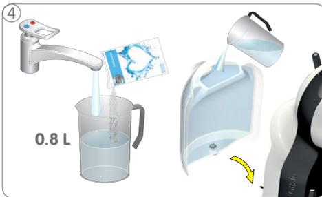
④ 0.8 Liter frisches Trinkwasser in einem Messbecher mit dem Inhalt des Entkalkerbeutels vermischen. Entkalkerlösung in den Wasserbehälter gießen und Wasserbehälter auf die Maschine stellen.
