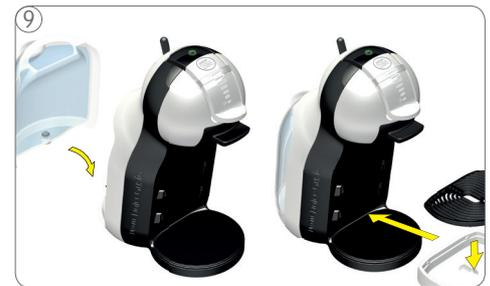
9 Abtropfgitter auf die Abtropfschale legen. Abtropfschale in der gewünschten Position an der Maschine anbringen.
