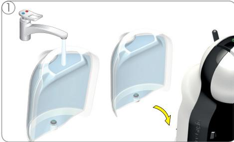
1 Wasserbehälter spülen. Wasserbehälter mit frischem Trinkwasser füllen und auf die Maschine stellen.
