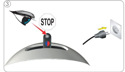
3 Sicherstellen, dass sich der Wahlhebel in der Position "STOP" befindet. Netzstecker in eine Steckdose einstecken.
