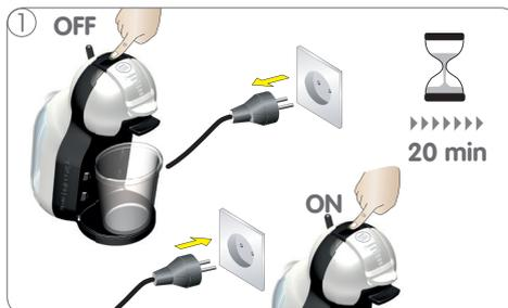
Maschine ausschalten. Überprüfen, ob die Kapsel blockiert ist (siehe Seite 12). Netzstecker ausstecken und 20 Minuten warten. Netzstecker wieder in die Steckdose stecken und Maschine einschalten.
