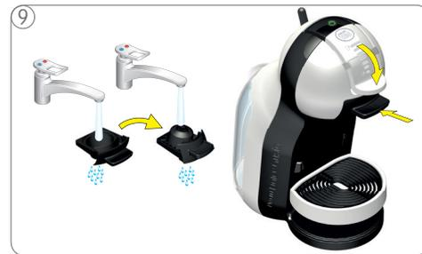
Kapselhalter auf beiden Seiten mit Wasser abspülen und abtrocknen. Kapselhalter in die Maschine einführen. Genießen Sie Ihr Getränk!
