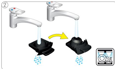
2 Kapselhalter auf beiden Seiten mit Wasser abspülen und abtrocknen. Auch die Reinigung in der Spülmaschine ist möglich.
