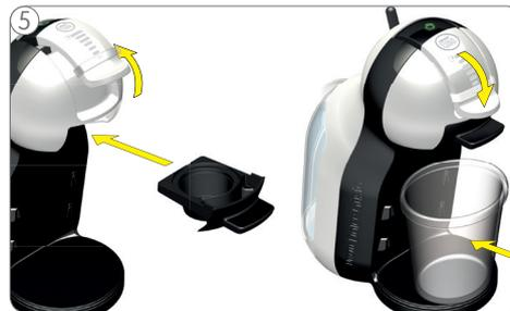
⑤ Arretierungsbügel öffnen und leeren Kapselhalter einführen. Schließen Sie den Arretierungsbügel. Platzieren Sie einen 1-Liter Messbecher unter dem Getränkeauslass.
