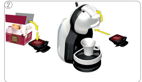
② Neue Kapsel in den Kapselhalter stecken und Kapselhalter wieder in die Maschine einführen.
