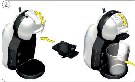
2 Arretierungsbügel öffnen und leeren Kapselhalter einführen. Arretierungsbügel schließen. Platzieren Sie einen 1-Liter Messbecher unter dem Getränkeauslass.
