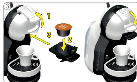
Arretierungsbügel öffnen und Kapselhalter herausziehen. Kapsel in den Kapselhalter stecken und Kapselhalter wieder in die Maschine einführen. Arretierungsbügel schließen.
