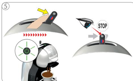
Bewegen Sie den Wahlhebel für heiße Getränke nach rechts und für kalte Getränke nach links. Die Getränkezubereitung startet. Warten Sie bis sich der Wahlhebel in die Mitte zurückbewegt und die Zubereitung abgeschlossen ist. Die Getränkezubereitung kann unterbrochen werden, indem Sie den Hebel in die mittlere Position zurück schieben.
