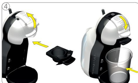
4 Arretierungsbügel öffnen und leeren Kapselhalter einführen. Schließen Sie den Arretierungsbügel. Platzieren Sie einen 1-Liter Messbecher unter dem Getränkeauslass.
