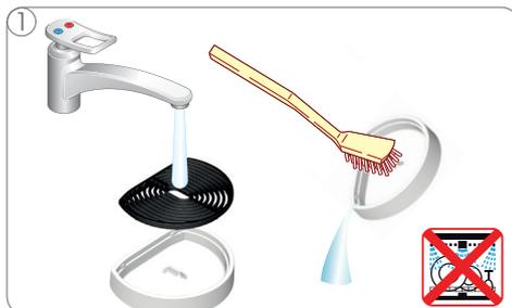
1 Abtropfschale mit Wasser abspülen und mit einer Bürste reinigen.
