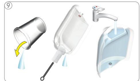
⑨ Leeren und reinigen Sie den Messbecher. Wasserbehälter spülen und reinigen. Anschließend mit frischem Trinkwasser füllen und auf die Maschine stellen.
