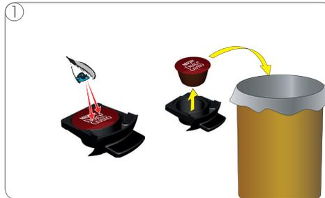
① Zubereitung beenden, Kapselhalter herausziehen und Kapsel überprüfen. In der Kapsel darf sich nur ein Loch befinden. Kapseln mit mehr als einer Öffnung entsorgen.
