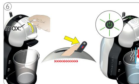
6 Balkenanzeige mit dem Dosierungsschieber auf Maximum stellen. Bewegen Sie den Wahlhebel nach rechts, um den Spülvorgang zu starten.
