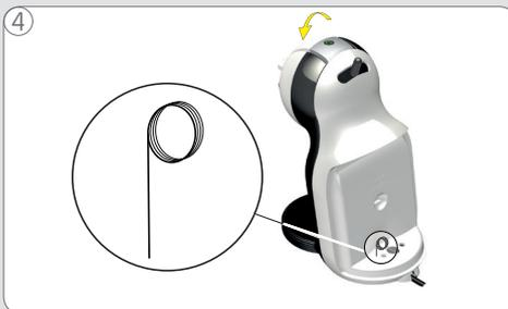
Wasserbehälter entfernen und Reinigungsnadel entnehmen. Arretierungsbügel schließen.
