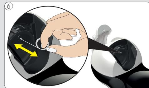
Düse mit der Reinigungsnadel reinigen.
