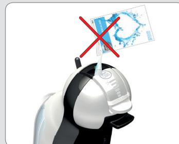
Entkalkerlösung nicht in Kontakt mit der Maschine bringen.
