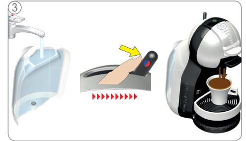
3 Überprüfen, ob sich Wasser im Wasserbehälter befindet: Wenn nein, Wasserbehälter auffüllen und Wahlhebel wieder in die Position "HEISS" bzw. "KALT" bringen, um mit der Zubereitung fortzufahren. Wenn der Wasserbehälter voll ist, folgendermaßen vorgehen:
