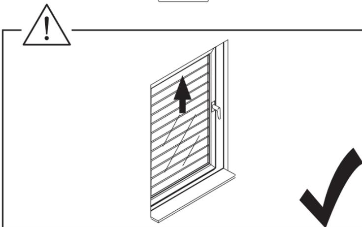
Rohrmotor nicht über Endlagen fahren. Beschädigungsgefahr.
