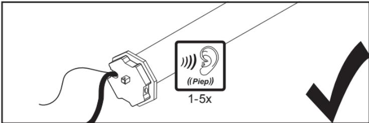
Bis zu 5 Rohrmotoren können pro Kanal angelernt werden. Jeder dieser Rohrmotoren muss eine eigene Adresse erhalten.
