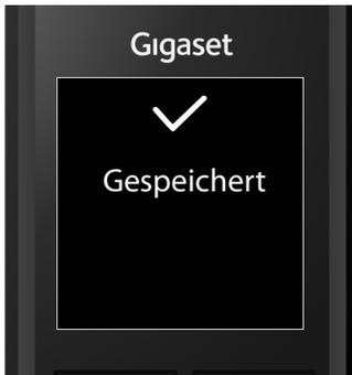
Im Display wird **Gespeichert** angezeigt. Sie hören einen Bestätigungston und kehren automatisch in den Ruhezustand, bzw. bei Einstellung über das Menü in das Menü „Einstellungen“, zurück.
