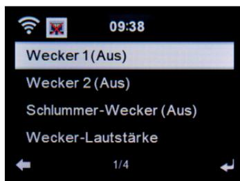
In diesem Menüpunkt können Sie bis zu 2 Weckzeiten einstellen. Außerdem kann hier eingestellt werden, ob der Wecker im Alarmfall mit einem Ton, einer Melodie, einer Internetradiostation, einer DAB+ Radiostation oder mit einer UKW (FM) Station weckt. Wenn Sie eine Alarmzeit eingerichtet haben, aktivieren Sie im Menü den Radioweckerbetrieb.
