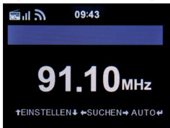
Das Gerät startet den automatischen Sendersuchlauf und speichert alle gefundenen Programm ab.
