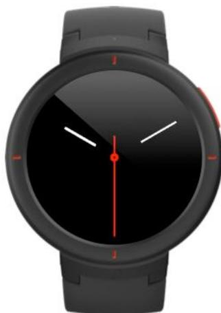
Wenn der Sperrbildschirmmodus eingeschaltet ist, wird der Sekundenzeiger auf dem klassischen oder digitalen Zifferblatt angezeigt, nachdem eine Handgelenkbewegung während des Ausschaltmodus erfasst wird, und unter Energiesparmodus leuchtet auch der Sekundenzeiger während der Standby-Zeit, nachdem die Handgelenkbewegung erfasst wird.
