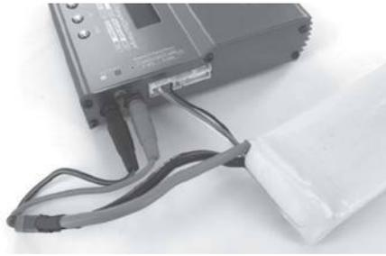
Bei Nichteinhaltung der in dieser Abbildung dargestellten Verbindung wird das Ladegerät beschädigt. Um Kurzschlüsse zwischen den Ladekabeln zu vermeiden, schließen Sie das Ladekabel immer zuerst an das Ladegerät und erst dann an den Akku an. Folgen Sie beim Trennen des Akkus der umgekehrten Reihenfolge.
