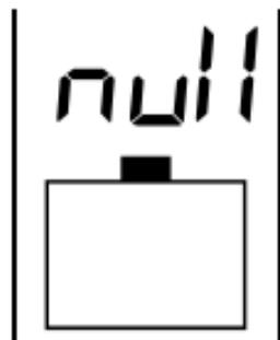
*"null" wird angezeigt – Es ist entweder kein Akku oder ein defekter Akku eingelegt.*
