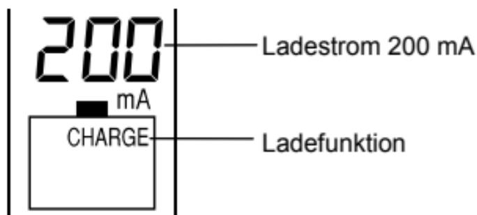
Während des Ladens können mit der "DISPLAY"-Taste die folgenden Anzeigen ausgewählt werden: Ladestrom (in mA), abgelaufene Zeit (in hh:mm), Anschluss-Spannung (in V) und geladene Kapazität (in mAh oder Ah) (siehe dazu Tabelle 4).
