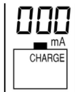
*Der Akku ist überhitzt und der Ladevorgang stoppt. Es wird "000 mA" angezeigt.*
