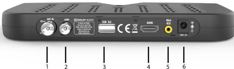
Bitte entnehmen Sie alle möglichen Anschlussmöglichkeiten Ihres Receivers dem Diagramm weiter unten. Verbinden Sie Ihren Receiver erst dann mit dem Stromnetz, wenn alle anderen Kabel richtig angeschlossen und überprüft wurden.
