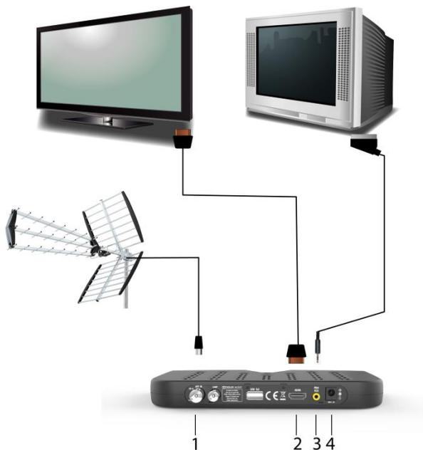
Verbinden sie den Receiver mit dem Antennenkabel von ihrer terrestrischen Antenne (1 im Bild). Danach verbinden sie den Receiver über ein HDMI-Kabel(2) oder minijack-Scartkabel(3) mit ihrem Fernseher. Zum Schluß stecken sie den Netzstecker(4) in die Steckdose.
