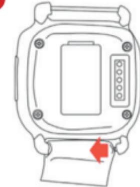
1. Das Armband ist über ein Gelenk mit der XPLORA verbunden. Schieben Sie das Armband am Gelenk leicht zur Seite, so dass der Federsteg zu sehen ist.
