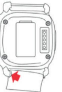
4. Setzen Sie das neue Armband mit dem Federsteg auf einer Seite in das Gelenk an der XPLORA ein.
