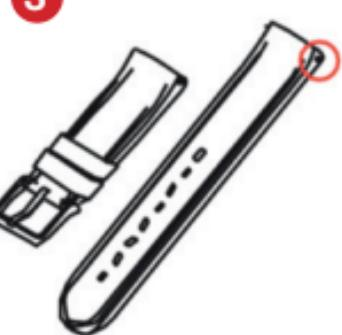
3. Nehmen Sie den Federsteg aus dem alten Armband heraus und setzen Sie ihn in das neue Armband ein.
