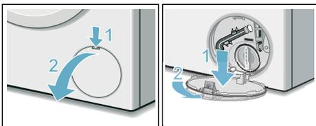
4. Entleerungsschlauch aus der Halterung nehmen.
