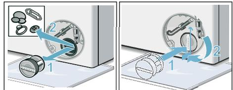
6. Service-Klappe einsetzen, einrasten und schließen.
