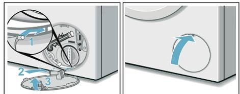
**Hinweis:** Um zu verhindern, dass beim nächsten Waschen Waschmittel ungenutzt in den Ablauf fließt: gießen Sie 1 Liter Wasser in Kammer II und starten das Programm Schleudern/Abpumpen (soll nur abgepumpt werden: U/min (Schleuderdrehzahl) auf - 0 - stellen).
