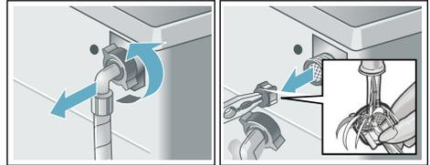
7. Schlauch anschließen und auf Dichtigkeit prüfen.
