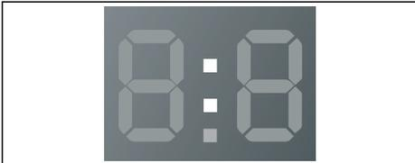
Wenn die Versorgungsspannung wieder stabil ist, läuft das Programm weiter. Der Doppelpunkt im Anzeigefeld blinkt nicht mehr.
