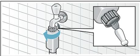
6. Bei Modellen Standard und Aqua-Secure Sieb an der Geräterückseite reinigen: Schlauch an der Geräterückseite abnehmen, Sieb mit Zange herausnehmen und reinigen.
