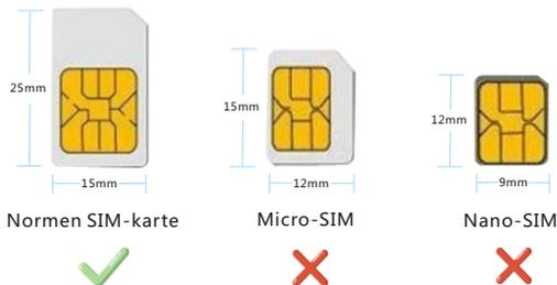
**Schritt 4:** Legen Sie die SIM-Karte richtig ein. Befolgen Sie die Abbildung auf der SIM-Karte Ihres Tablets, setzen Sie die goldenen Kontakte der Standard-SIM-Karte verdeckt ein und schieben Sie sie vorsichtig in den SIM-Kartensteckplatz, bis sie einrastet.
