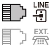
Stellen Sie beim Anschluss des Telefons an den Drucker sicher, dass der Drucker ausgeschaltet ist. Stecken Sie ein Ende des modularen Kabels in die Buchse für externe Geräte in der Nähe der Markierung "EXT." am Drucker, und stecken Sie das andere Ende in die Buchse für Telefonkabel des Telefons.
