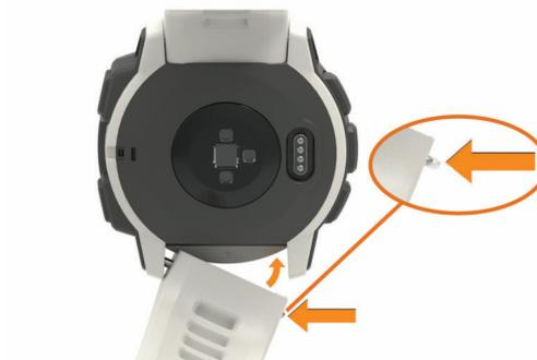
**HINWEIS:** Vergewissern Sie sich, dass das Armband sicher befestigt ist. Der Stift der Uhr muss auf die Löcher am Gerät ausgerichtet sein.
