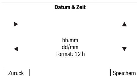
Stellen Sie die Uhrzeit „hh:mm“, das Datum „dd/mm“ und das Uhrzeitformat „Format: 12 h“ ein. Wählen Sie dazu die Eingabeposition mit dem Rechts-/Links-Cursor aus, stellen Sie mit dem Auf-/Ab-Cursor die Ziffern ein und bestätigen Sie mit **„Speichern“** oder wählen Sie **„Zurück“**, um zur vorherigen **„PIN-Code“** zurückzukehren.
