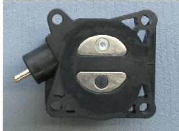
Elektromagnet mit z.B einem Glasreiniger reinigen und leicht mit einen säurefreien Silikonfett einfetten z.B Art. 1240-00.600.42.
