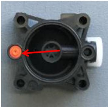
Steuerdüse mit Pressluft reinigen
