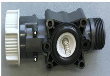
Membrane vollst, Druckfeder groß in Ventilkörper einsetzen
