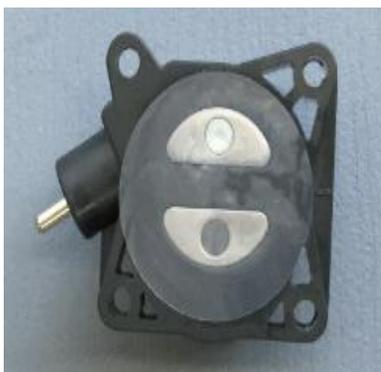
Mylar Folie des Elektromagneten abziehen
