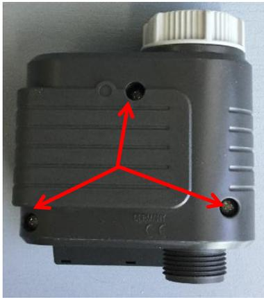
3 Schrauben mit Schraubendreher Torx 20 lösen.
