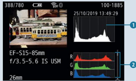
Abbildung 4.16 Das Histogramm für die einzelnen Farbkanäle
