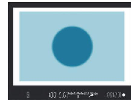
Abbildung 4.38 Die Mittenbetonte Messung
