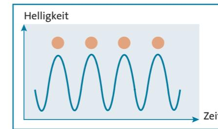
**Abbildung 4.30** Bei aktivierter Flacker-Erkennung wird erst in der hellsten Phase ausgelöst.
