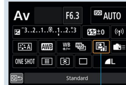
Abbildung 4.17 Mit dem markierten Symbol rufen Sie die **Automatische Belichtungsoptimierung** auf.
