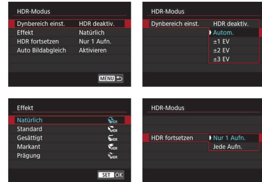
Abbildung 4.27 Das HDR-Modus-Menü mit seinen Optionen: Beim Dynamikbereich (**Dynbereich einst.**) führt **Autom.** meist zu optimalen Ergebnissen. Wählen Sie unter **HDR fortsetzen** die Option **Jede Aufn.**, um kontinuierlich HDR-Aufnahmen zu erstellen. Der **Auto Bildabgleich** hilft bei Aufnahmen aus der freien Hand.
