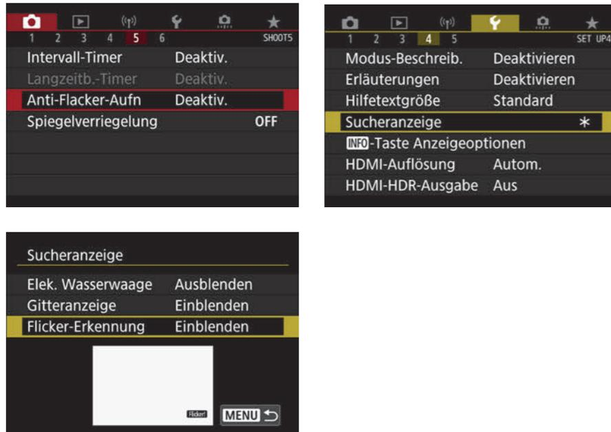
Abbildung 4.32 Über die Einstellungen unter **Sucheranzeige** legen Sie fest, ob eine Flackerwarnung im Sucher erfolgt. Nur bei aktivierter Korrektur wird der Auslösevorgang an die Beleuchtung angepasst.
