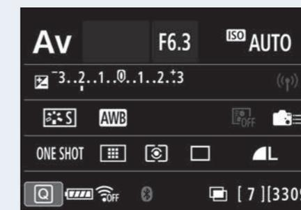
Abbildung 4.45 Auf dem Monitor sehen Sie rechts unten die Anzahl der verbliebenen Mehrfachbelichtungen, hier: »7«.
