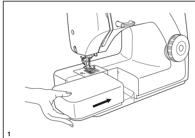
Das Innere des Anschietisches kann als Zubehörfach verwendet werden.
